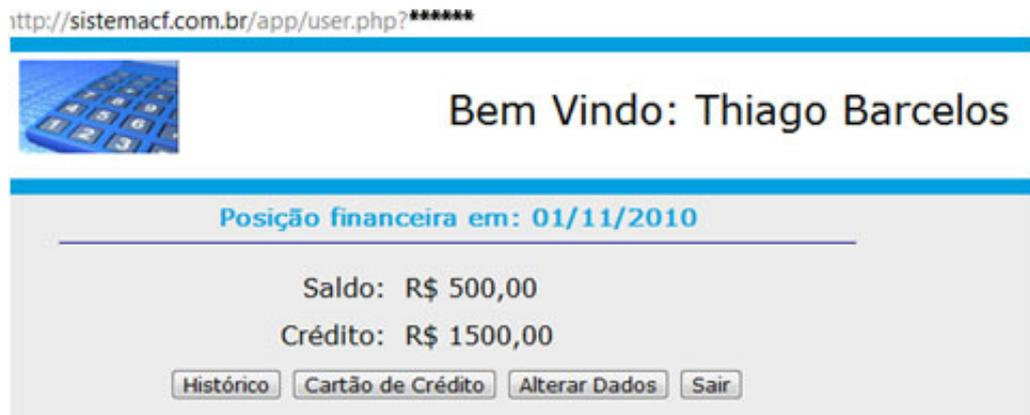
FIGURA 8 - Inserção de dados inválidos na aplicação através da manipulação de URL.
